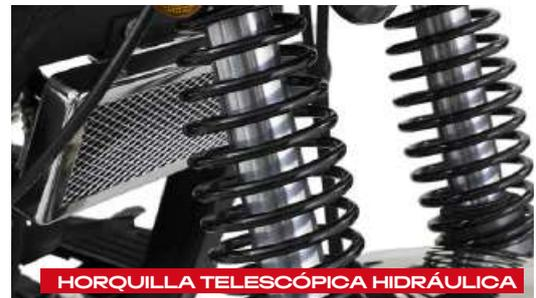
HORQUILLA TELESCÓPICA HIDRÁULICA
